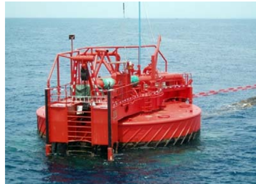
รูปที่ 3-32 ทู่นรับน้ำมันกลางทะเล
