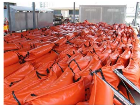
รูปที่ 3-12 พุนกักน้ำมันแบบไม่สูบลม
